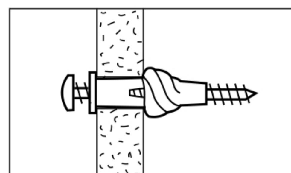
金屬螺絲在石膏材質的牆壁中無法緊固，因此**務必先嵌入壁虎**：您可在牆面上標註後鑽孔，再將壁虎捶入孔洞，之後就可以鎖螺絲了。記得，為了避免壁虎鬆脫，螺絲長度應大於壁虎長度。
