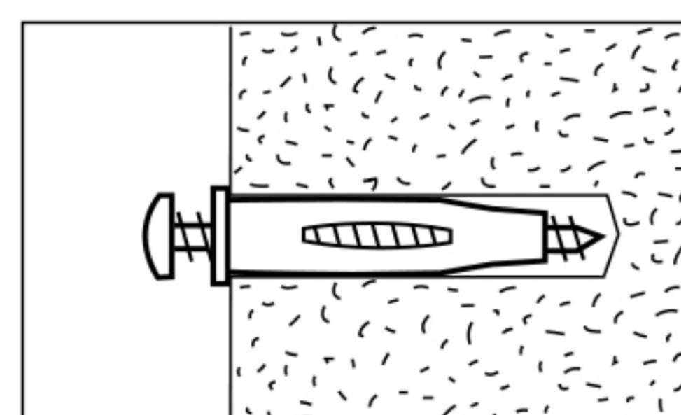
水泥牆面必須預先鑽好螺絲孔洞，並搭配塑膠壁虎。您可在牆面上標註後鑽孔，再將壁虎捶入孔洞，之後就可以鎖螺絲了。記得，為了避免壁虎鬆脫，螺絲長度應大於壁虎長度。
