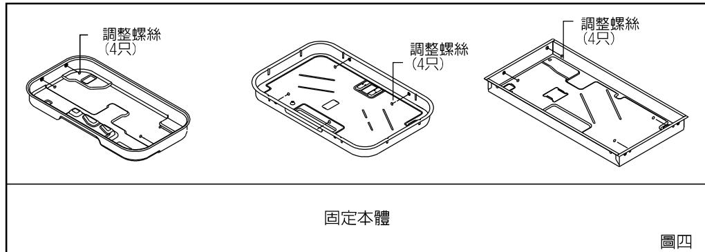
3. 將天板放置往本體上，並調至適當的位置，並使用螺絲包內的螺絲將天板押板鎖固在本體上。
